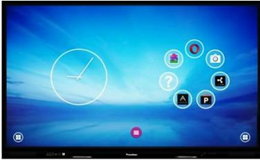
Ein Touch Board ist ein berührungsempfindlicher TFT<sup>38</sup>. Die zur Verfügung stehenden Funktionen werden durch einen Personalcomputer gesteuert, der je nach Ausstattung mit dem Betriebssystem Windows 10, Android oder iOS läuft.
