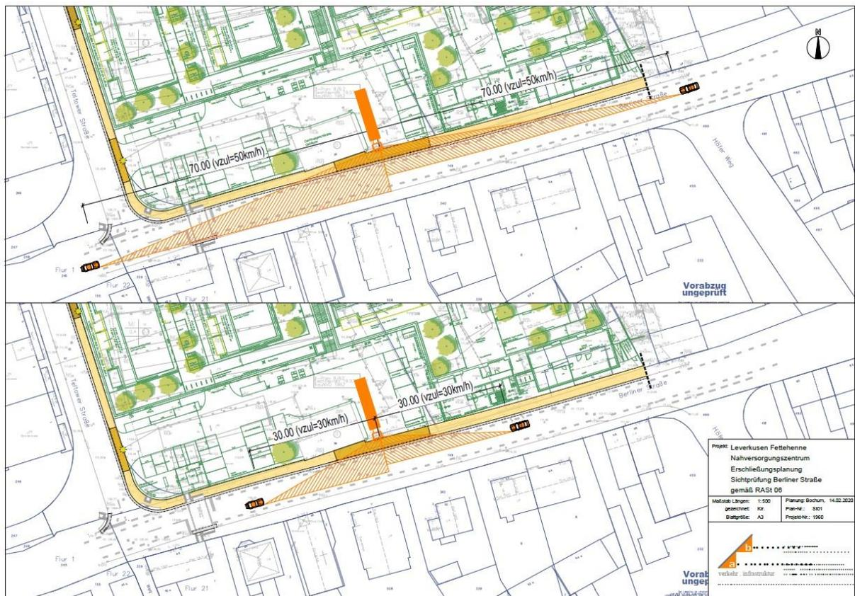
Abbildung 9: Überprüfung der Sichtfelder bei der Ausfahrt zur Berliner Straße
