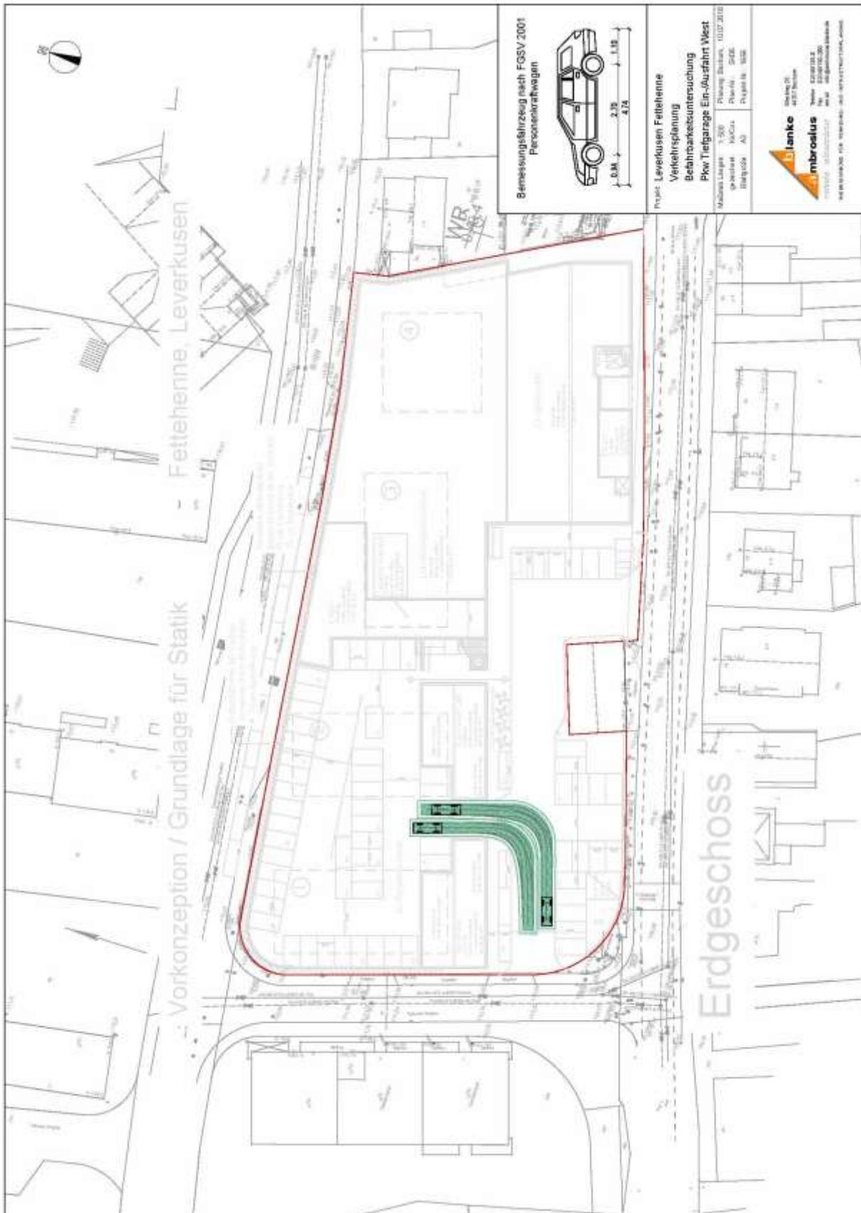
Abbildung 6: Befahrbarkeitsüberprüfung Ein-/Ausfahrt West Pkw
