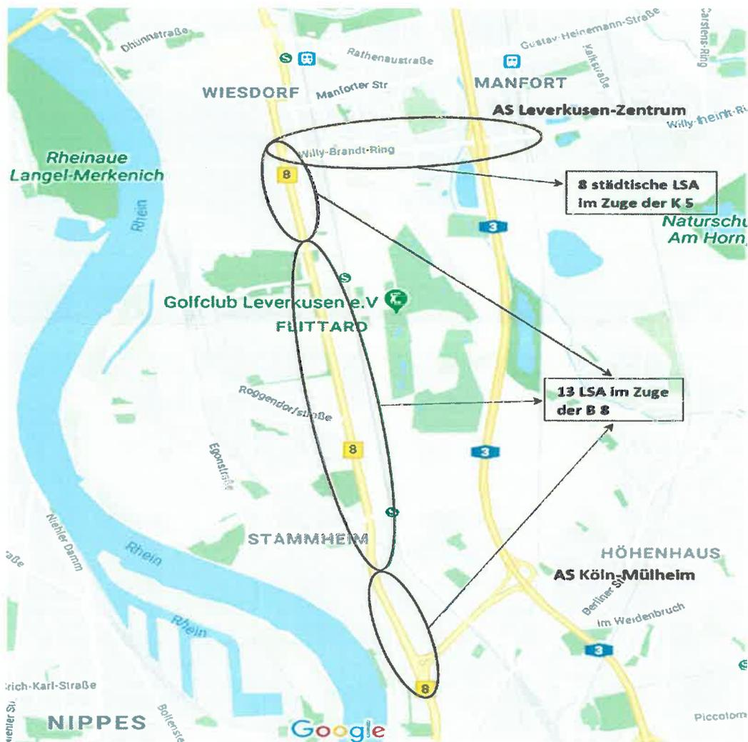
Durch eine stetige Verkehrsführung und koordinierte Netzsteuerung der städtischen LSA im Zuge der K 5 (Willy-Brandt-Ring) mit den LSA im Zuge der B 8 ließen sich zudem eine Verringerung der erforderlichen Halte- und Beschleunigungsvorgänge und damit auch der Lärm- und Abgasemissionen erzielen. Die Maßnahme könnte daher u.a. auch als eine essentielle Maßnahme im Luftreinhalteplan der Stadt ausgewiesen werden.
