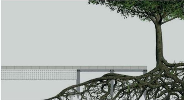
Abbildung 5: schematische Zeichnung einer **Wurzelbrücke ArborGrid** (Quelle: Firma Greenleaf, Reichshof-Hunsheim)
