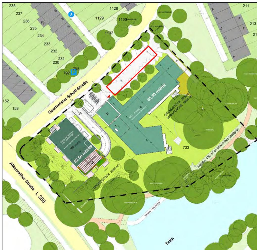
Abbildung 1: Lageplan mit Eintragung der potenziellen Versickerungsfläche [1]
