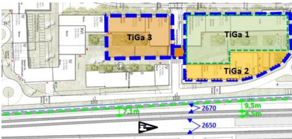
Abbildung 4: Skizze Abstände der Gleise zueinander nach Ausbau RRX
