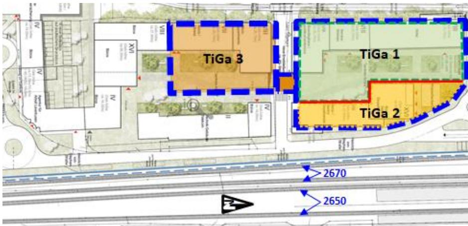
Abbildung 2: Skizze Ausdehnung der Tiefgaragen (blau umrandet) und vertikaler elastischer Trennung (rote Linie) [8],
