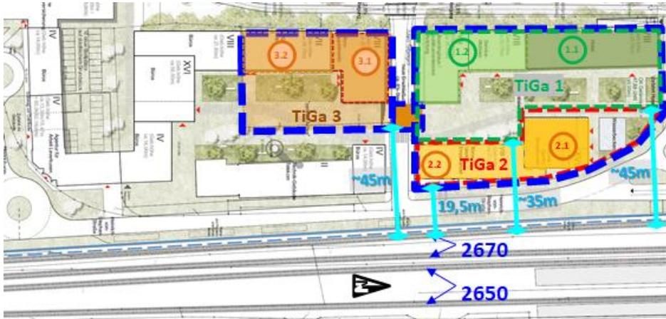
Abbildung 5: Planskizze mit maßgeblichen Abständen zum Gleis 1 Strecke 2670 Fahrtrichtung Süd (in Planung befindlich)
