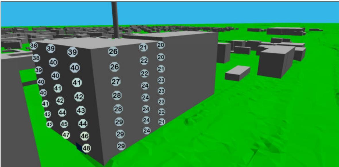
**Abb. 8.5.4** Immissionspegel im Bereich der Tiefgaragenausfahrt HA 3.1 - nachts -
