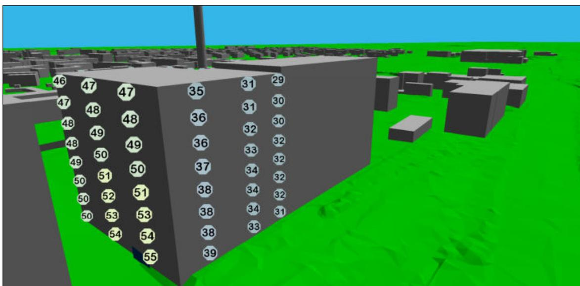
**Abb. 8.5.3** Immissionspegel im Bereich der Tiefgaragenausfahrt HA 3.1 - tags -
