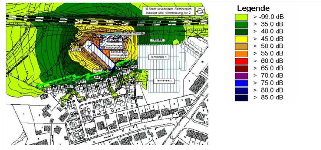
Abb. 5 - Sportlärm (Schießanlage) Tagsüber in 5 m Höhe über Grund
