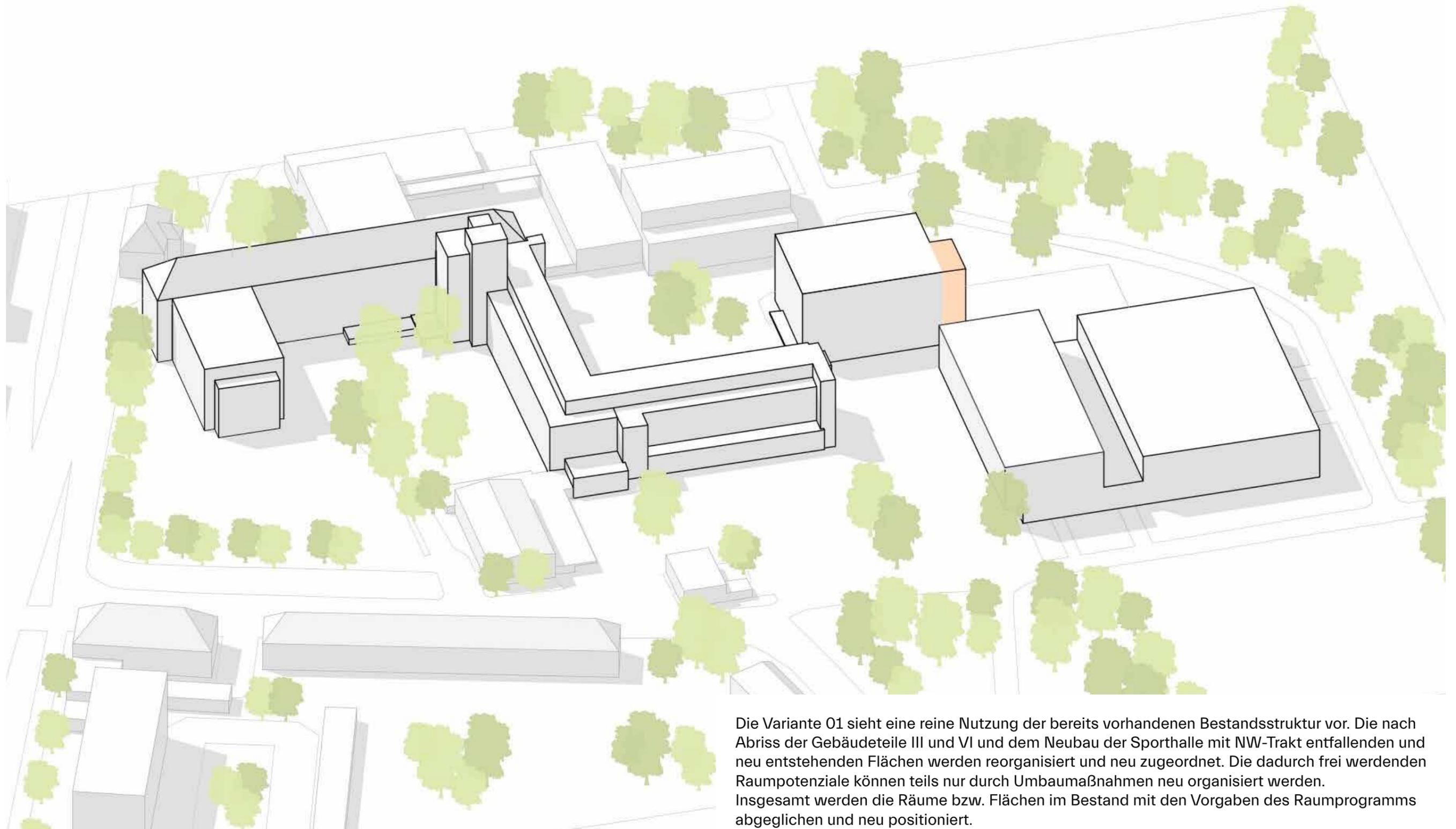
Die Variante 01 sieht eine reine Nutzung der bereits vorhandenen Bestandsstruktur vor. Die nach Abriss der Gebäudeteile III und VI und dem Neubau der Sporthalle mit NW-Trakt entfallenden und neu entstehenden Flächen werden reorganisiert und neu zugeordnet. Die dadurch frei werdenden Raumpotenziale können teils nur durch Umbaumaßnahmen neu organisiert werden. Insgesamt werden die Räume bzw. Flächen im Bestand mit den Vorgaben des Raumprogramms abgeglichen und neu positioniert.
