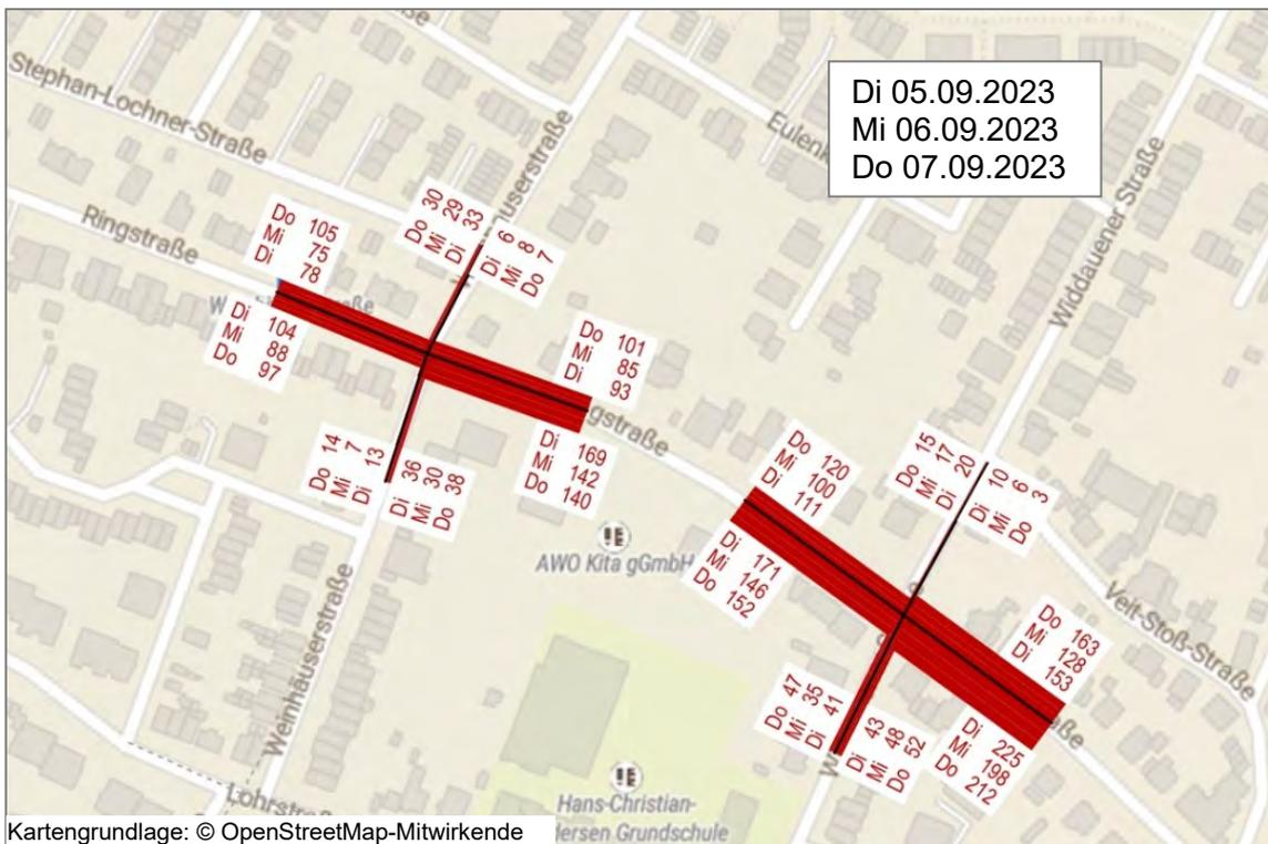
Abbildung 2-10: Ergebnis der Verkehrszählung vom 05.–07.09.2023 an den Knotenpunkten 7 und 8, **Morgenspitzenstunde [Kfz/h]**
