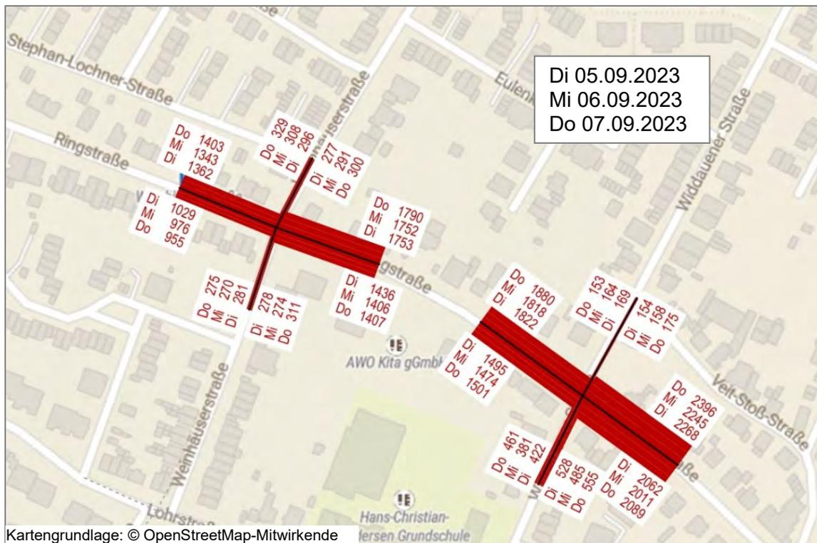
Abbildung 2-6: Ergebnis der Verkehrszählung 05.--07.09.2023 an den Knotenpunkten 7 und 8 – Kfz/24 h
