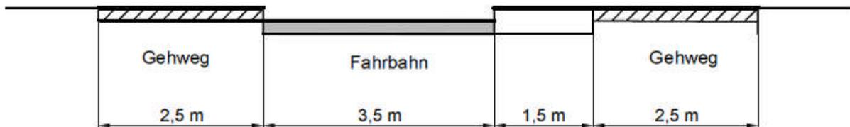
Abb. 5-1: Beispiel-Querschnitt Engstelle mit Querungsmöglichkeit
