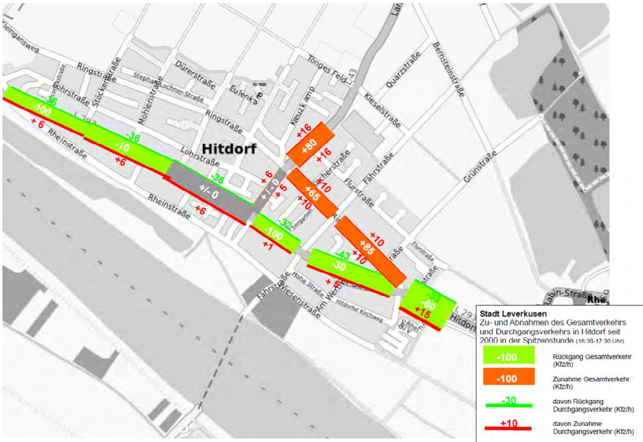
Abb. 3-21: Zu- und Abnahmen der Verkehrsstärken und Durchgangsverkehre in Hitdorf zwischen 2000 und 2010
