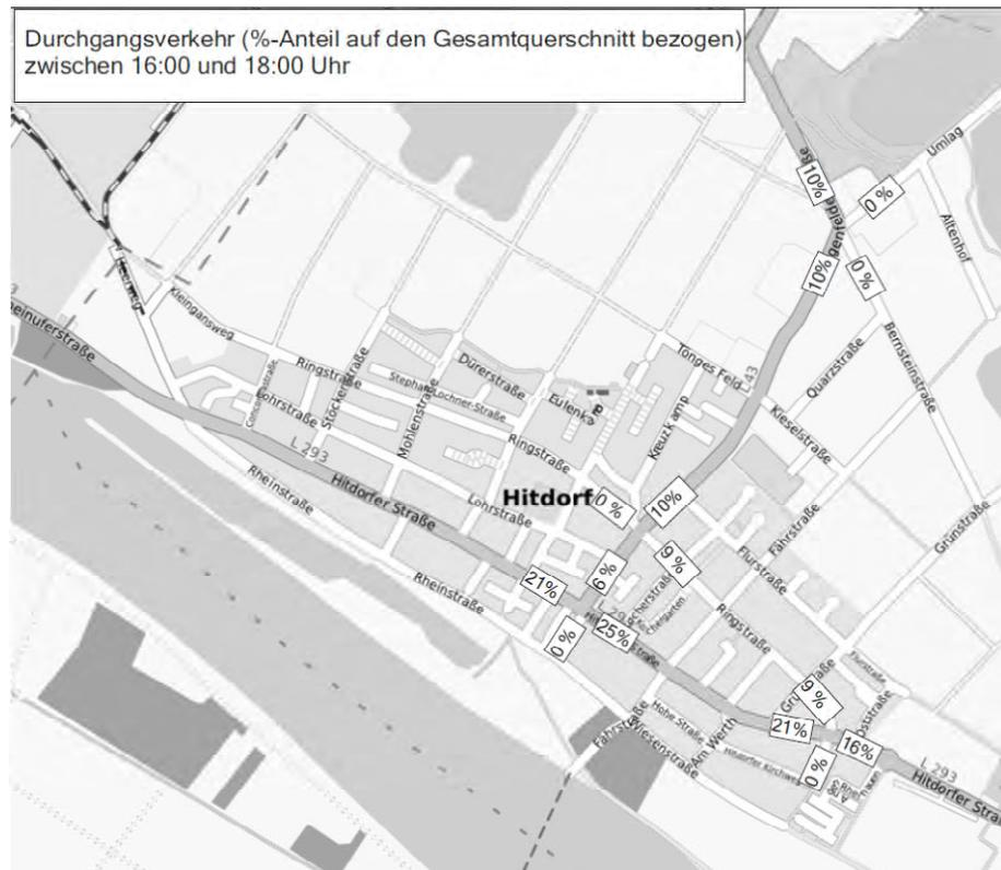
Abb. 3-20: Anteile des Durchgangsverkehrs auf den Querschnitt bezogen (26.10.2010, 16:00-18:00 Uhr)
