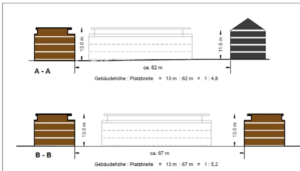
Schematischer Platzschnitt – Nord-Süd (A-A) und Ost-West (B-B)
