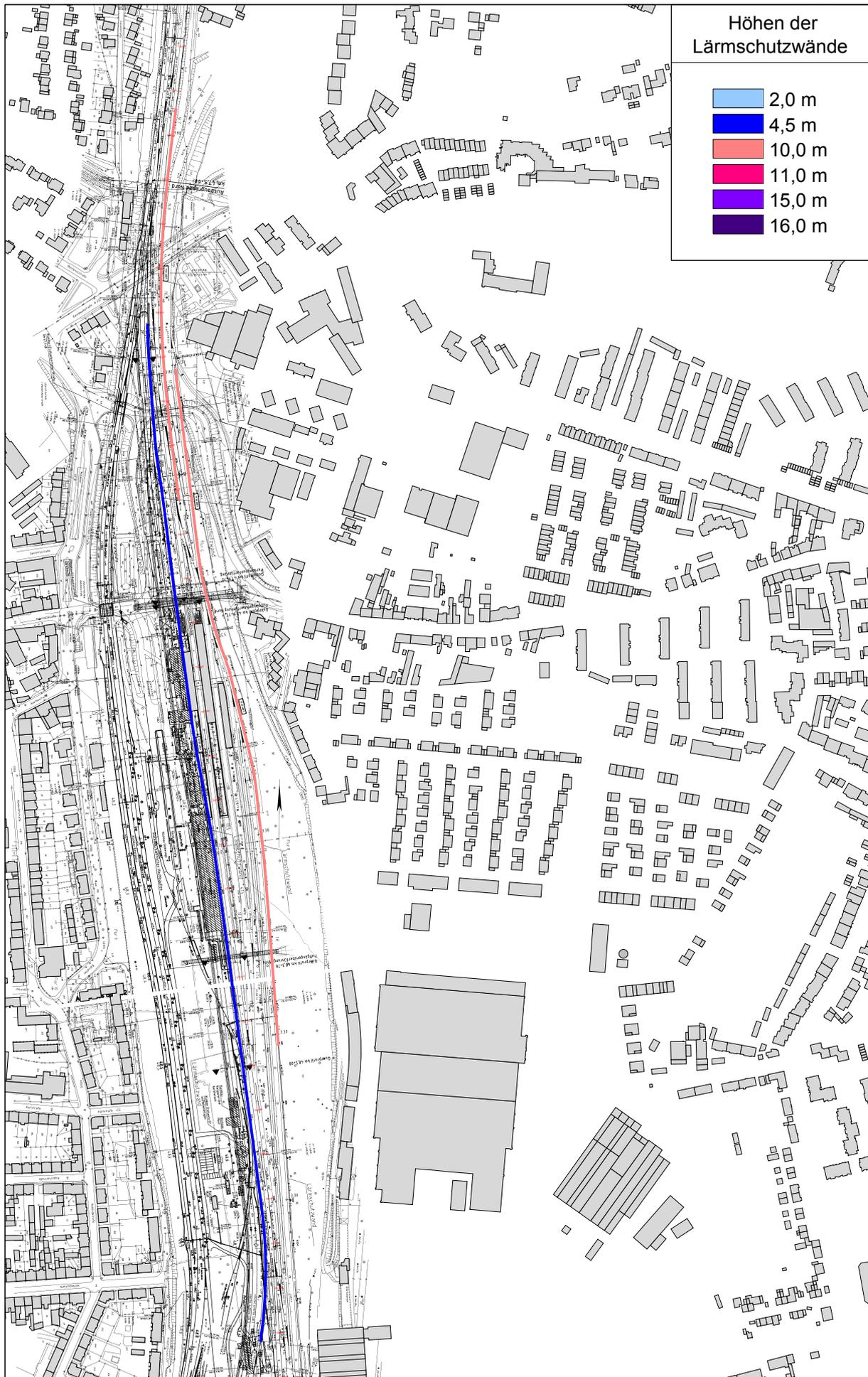
Abb. 5.2.2.2 Lage der Lärmschutzwände Variante 2
