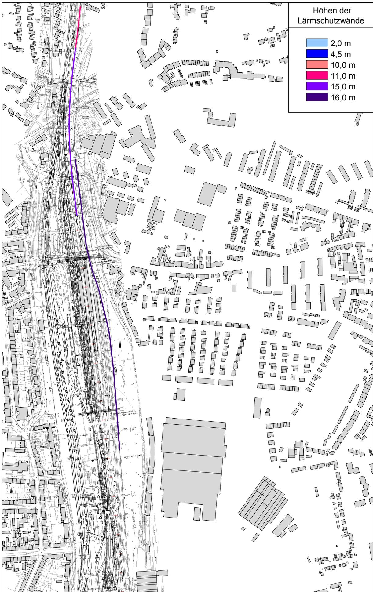
Abb. 5.2.2.1 Lage der Lärmschutzwände Variante 1
