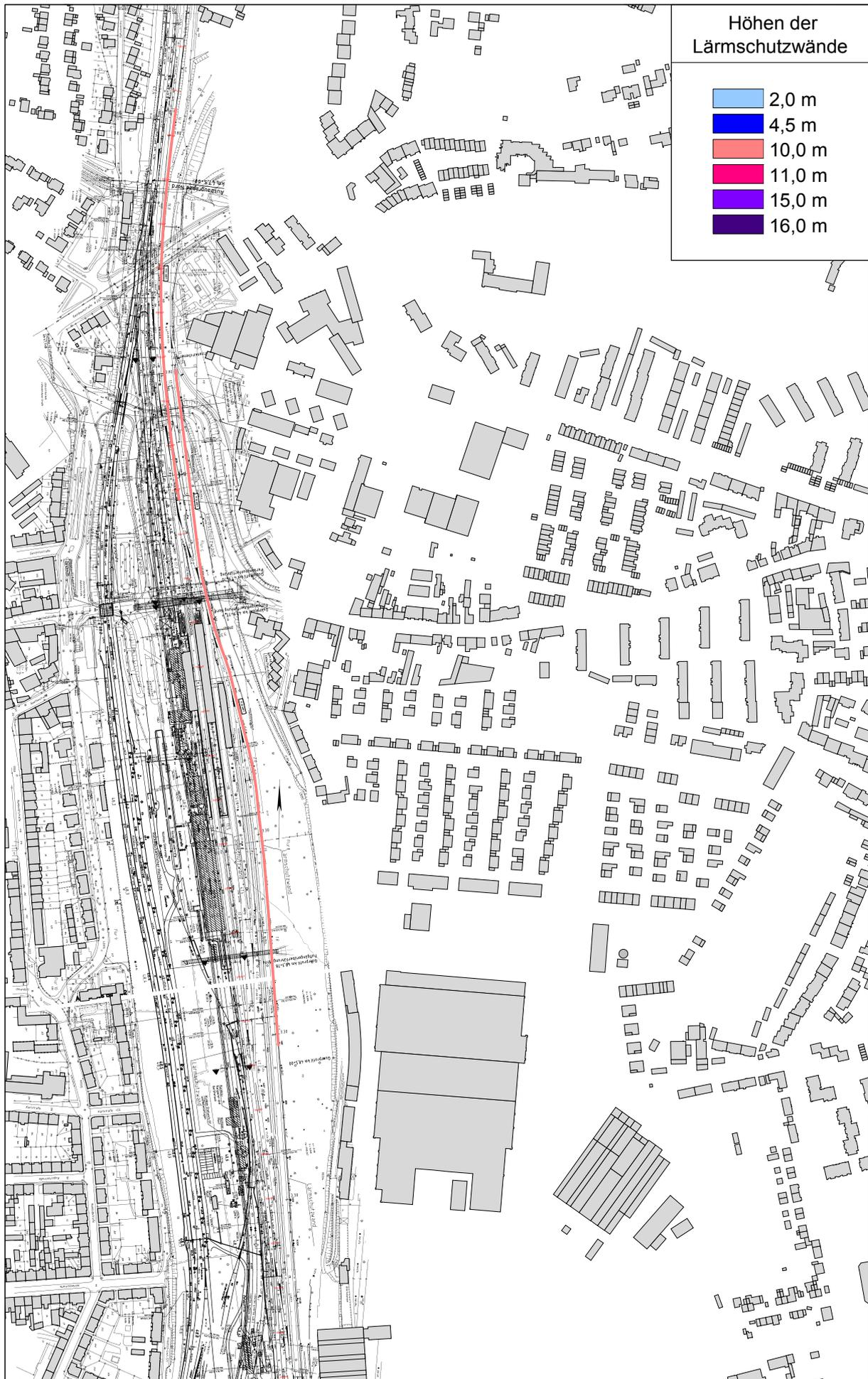
Abb. 5.2.2.3 Lage der Lärmschutzwände Variante 3
