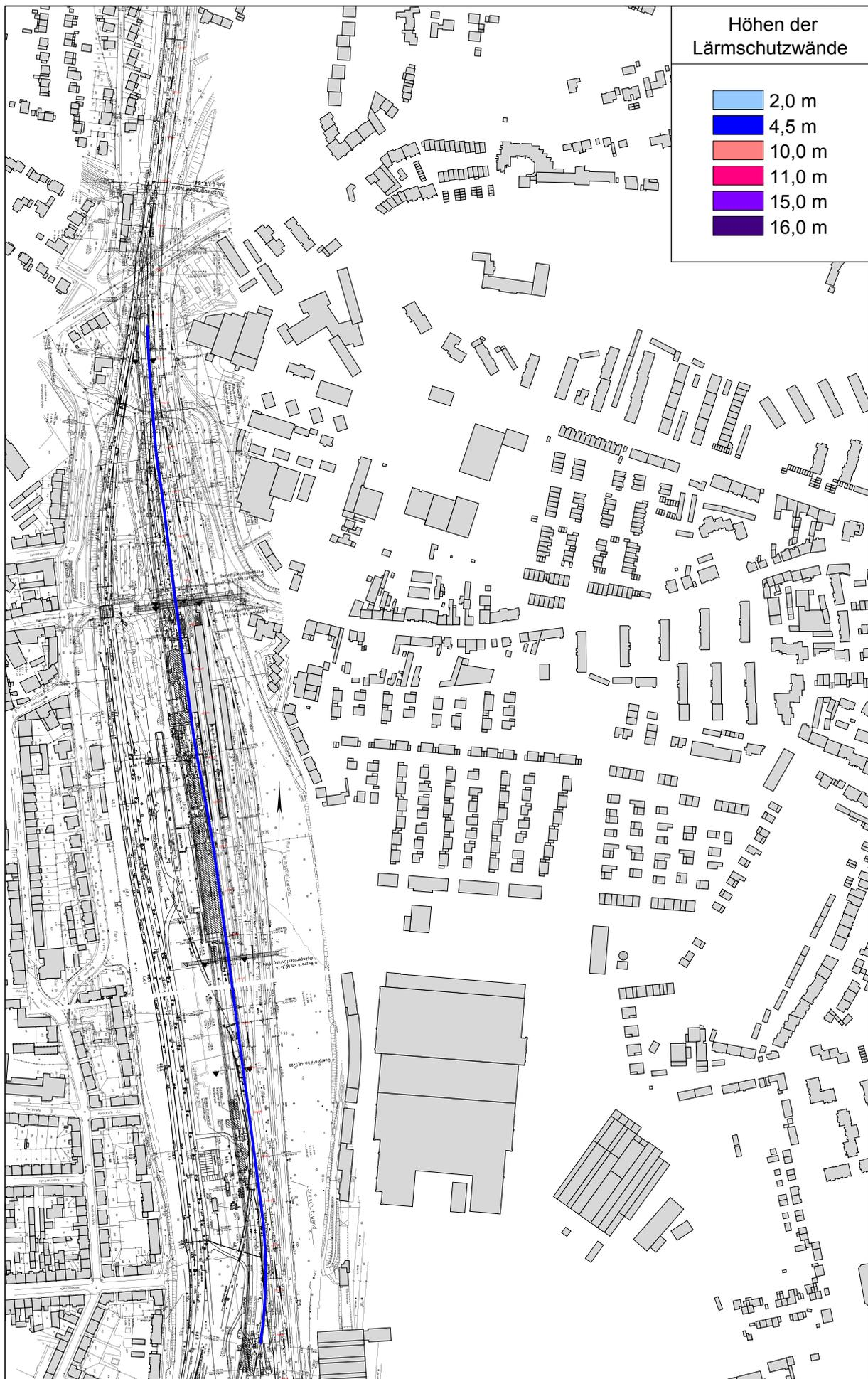
Abb. 5.2.2.4 Lage der Lärmschutzwände Variante 4
