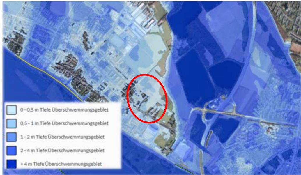
Abbildung 3: Hochwassergefahrenkarte, Szenario HQ<sub>500</sub> (verändert nach [www.uvo.nrw.de](http://www.uvo.nrw.de), Zugriff am 20.02.2017)
