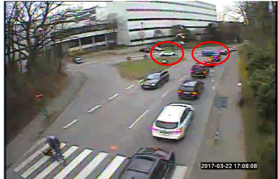
Bei Rückstau wird Fahrzeugen aus der Stauffenbergstraße das bevorrechtigte Einfädeln ermöglicht (blaues und weißes Fahrzeug)
