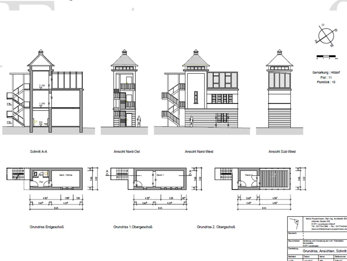
Um eine maximale Ausnutzung der Räumlichkeiten zu ermöglichen, wurde auf eine innenliegende Treppe verzichtet und an der nordöstlichen Turmseite eine verzinkte Stahltreppe mit Überdachung geplant.
