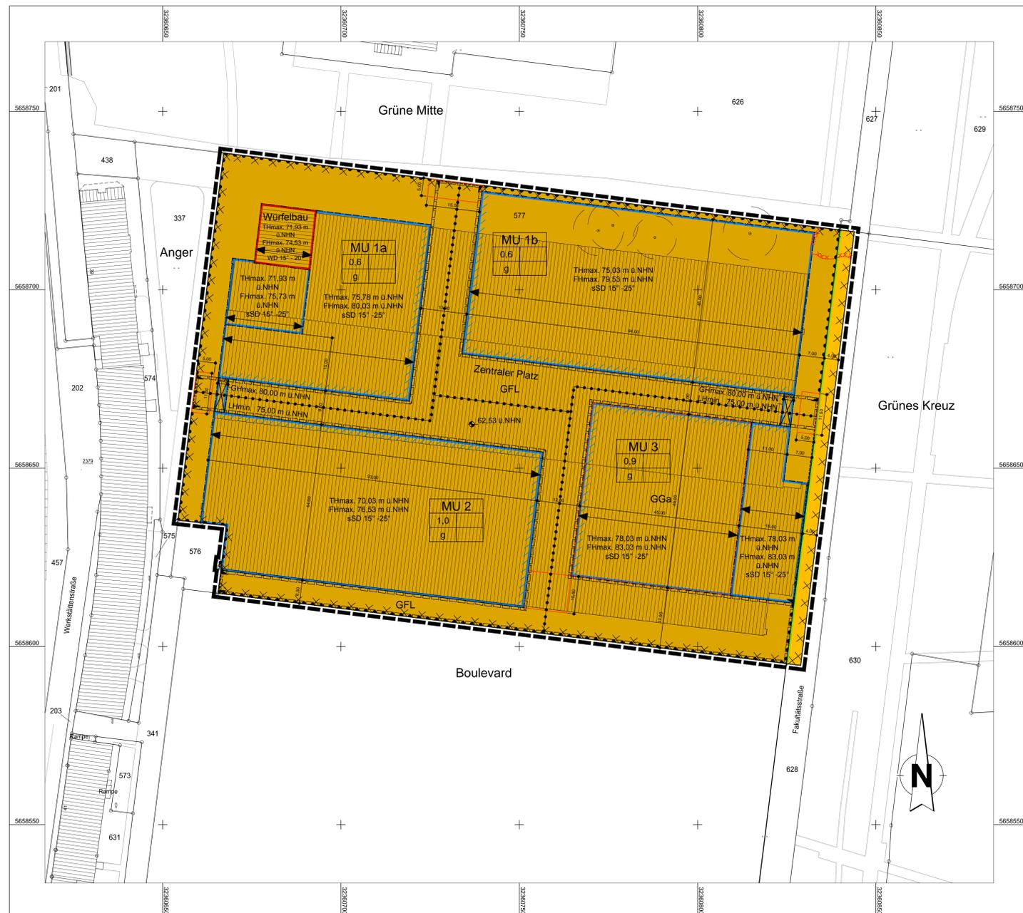
Ergebnisse der Immissionsberechnungen "Verkehrslärm" Flächenhafte Darstellung der Außenlärmpegel im Plangebiet zum Tageszeitraum gemäß DIN 4109 der Fassung von 2018, Rechenhöhe = 12m über Gelände
