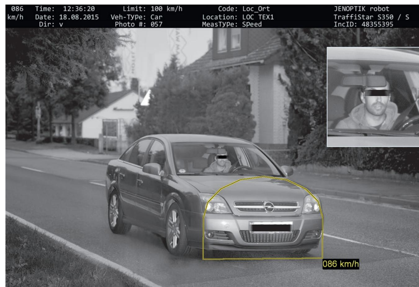
TraffiStar S 350-Ergebnisaufnahme mit eingeblendetem Auswerterahmen und zugeordnetem Geschwindigkeitswert
