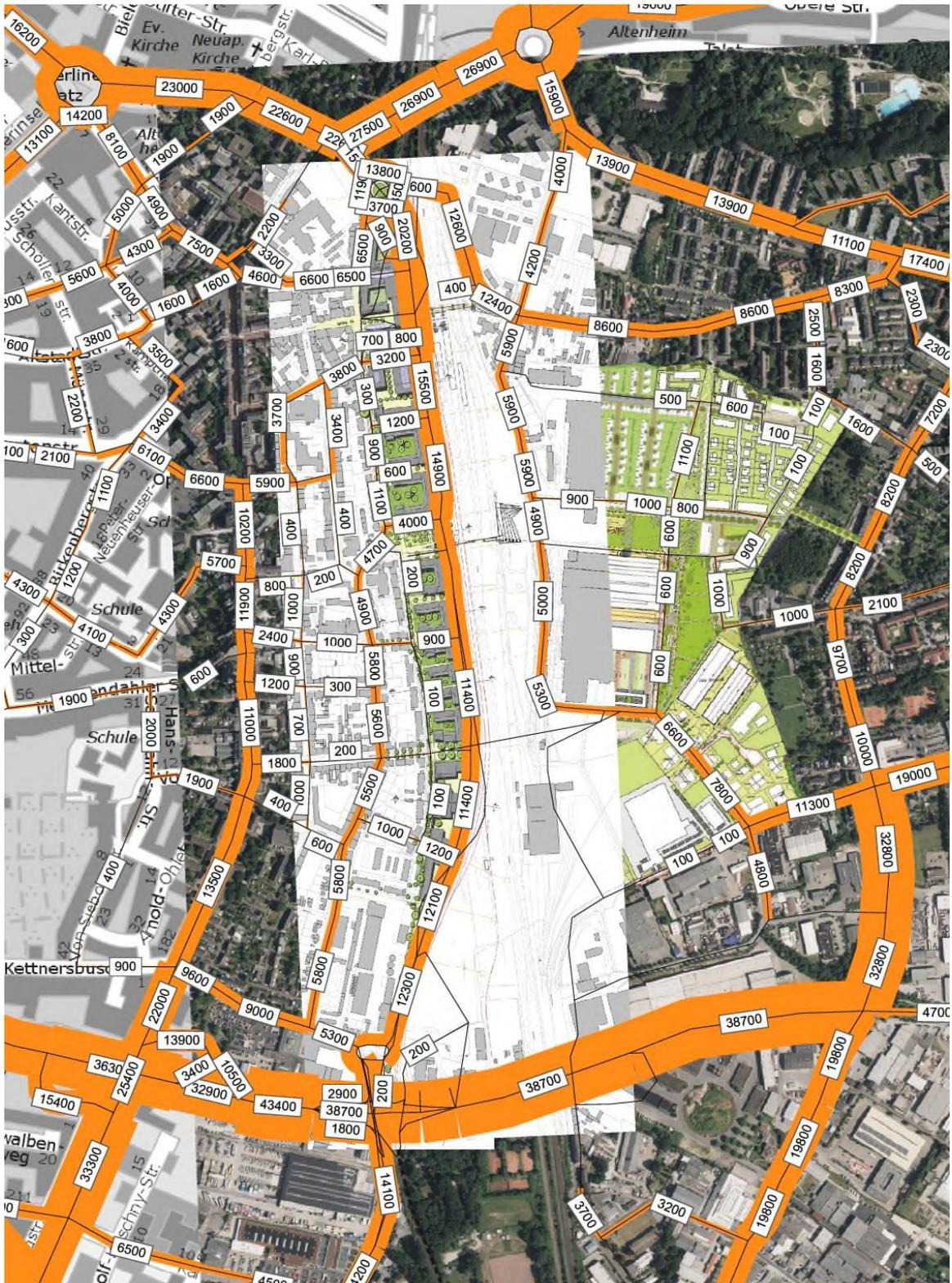
Abb. 5-7: Verkehrsbelastung ( $DTV_w$ ) in Variante G2 „Durchbindung“ 2030
