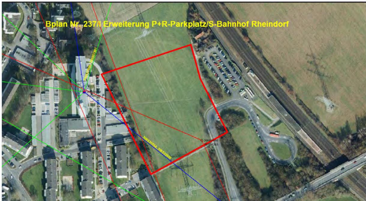
Die farbigen Linien verstehen sich als Punkt-zu-Punkt-Richtfunkverbindungen der E-Plus Service GmbH. Das Plangebiet ist im Bild mit einer dicken roten Linie eingezeichnet. Die Linien in Rot haben für Sie keine Relevanz.
