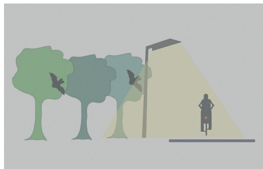
Abbildung 5.4 Vermeidung unnötiger Lichtverschmutzung durch die Installation abgeschirmter Leuchten. Links - konventionelle Leuchte mit Abstrahlung in den angrenzenden Waldlebensraum, rechts - abgeschirmte Leuchte, die den Lichtkegel nur dorthin fokussiert, wo er benötigt wird (© H. LIMPENS).
