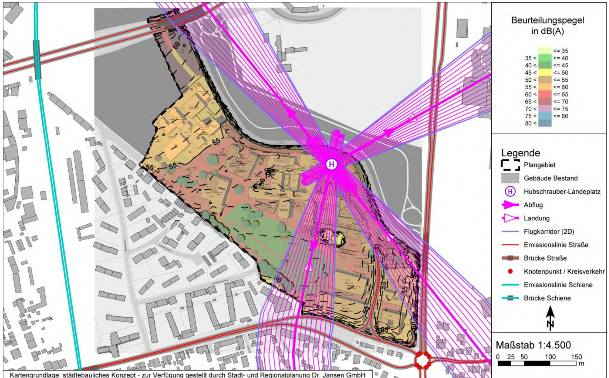
Anlage 6.13: Flächenhafte Darstellung der Beurteilungspegel aus Verkehrslärm bei freier Ausbreitung, Rechenhöhe 2m, Nacht (mit hinterlegtem städtebaulichen Konzept)
