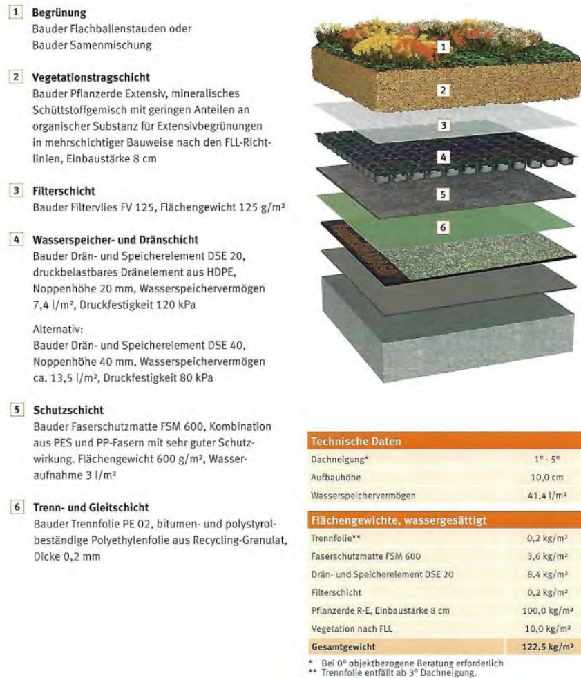
Abbildung 14: Aufbau Dachbegrünung
