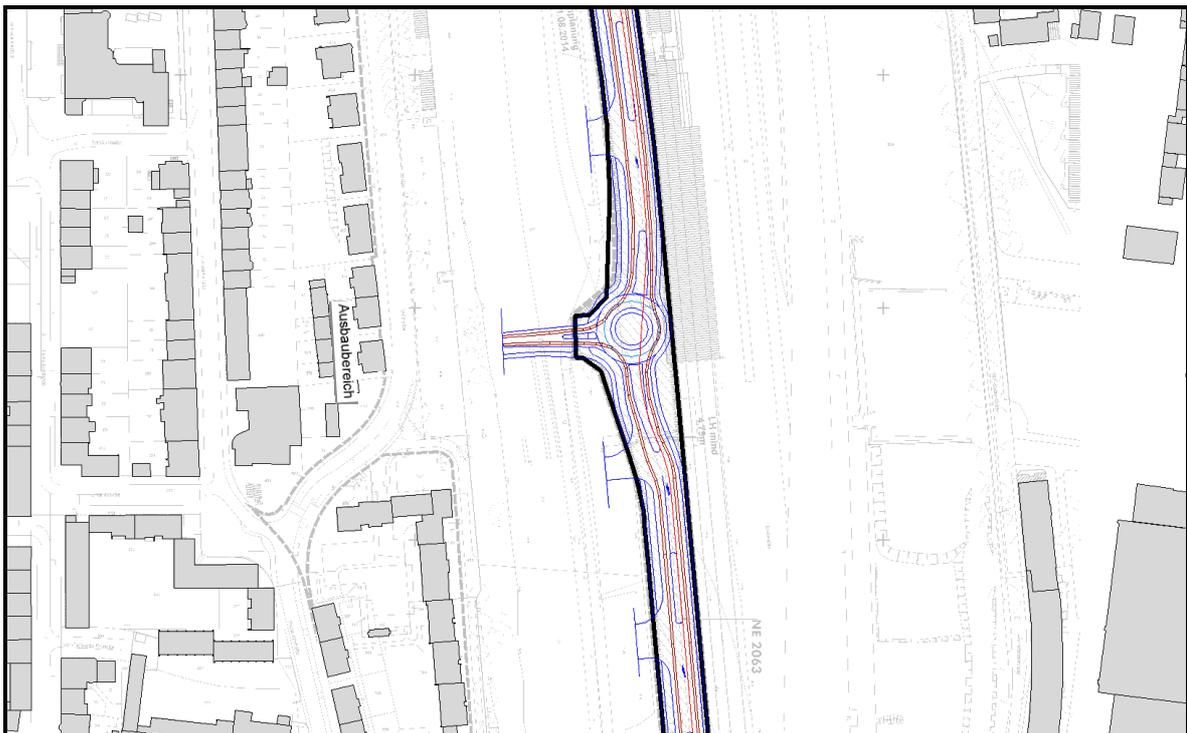
**Abb. 2.4.4** Lage der Fahrstreifen im Mittelknoten
