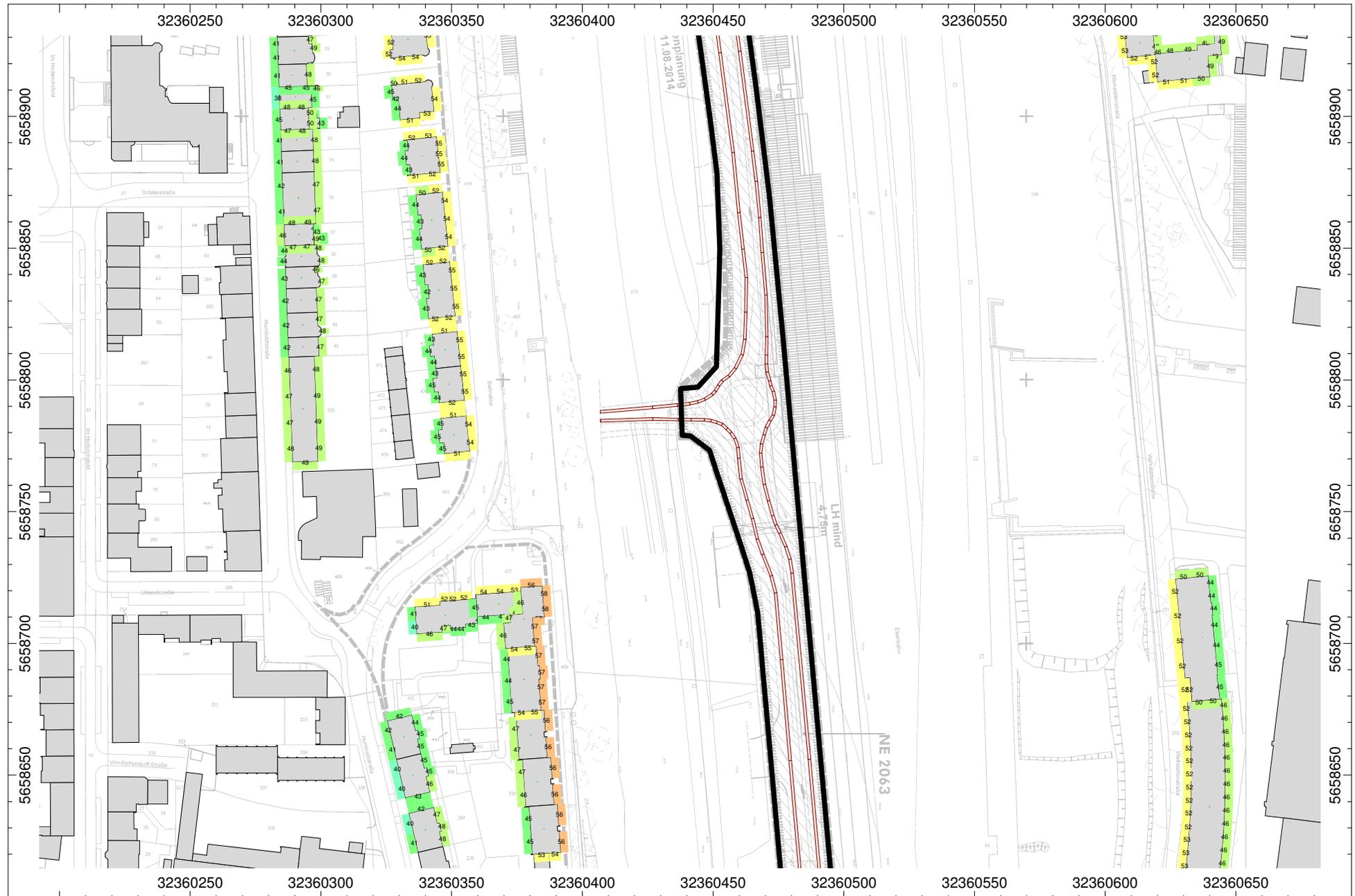
Abb. 3.2.5 maximale Fassadenpegel innerhalb des Ausbaubereichs tags - Teil 3
