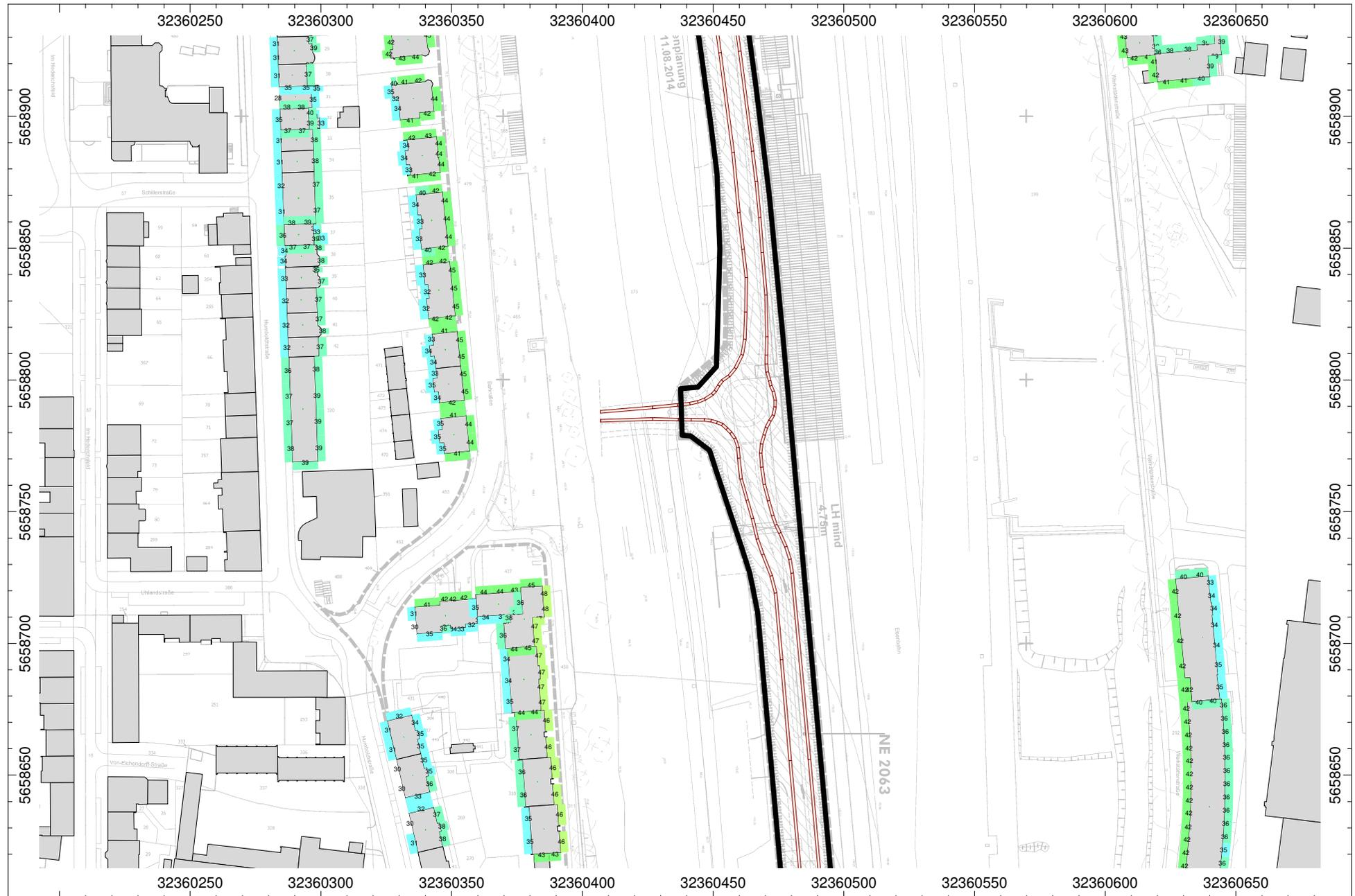
Abb. 3.2.6 maximale Fassadenpegel innerhalb des Ausbaubereichs nachts - Teil 3
