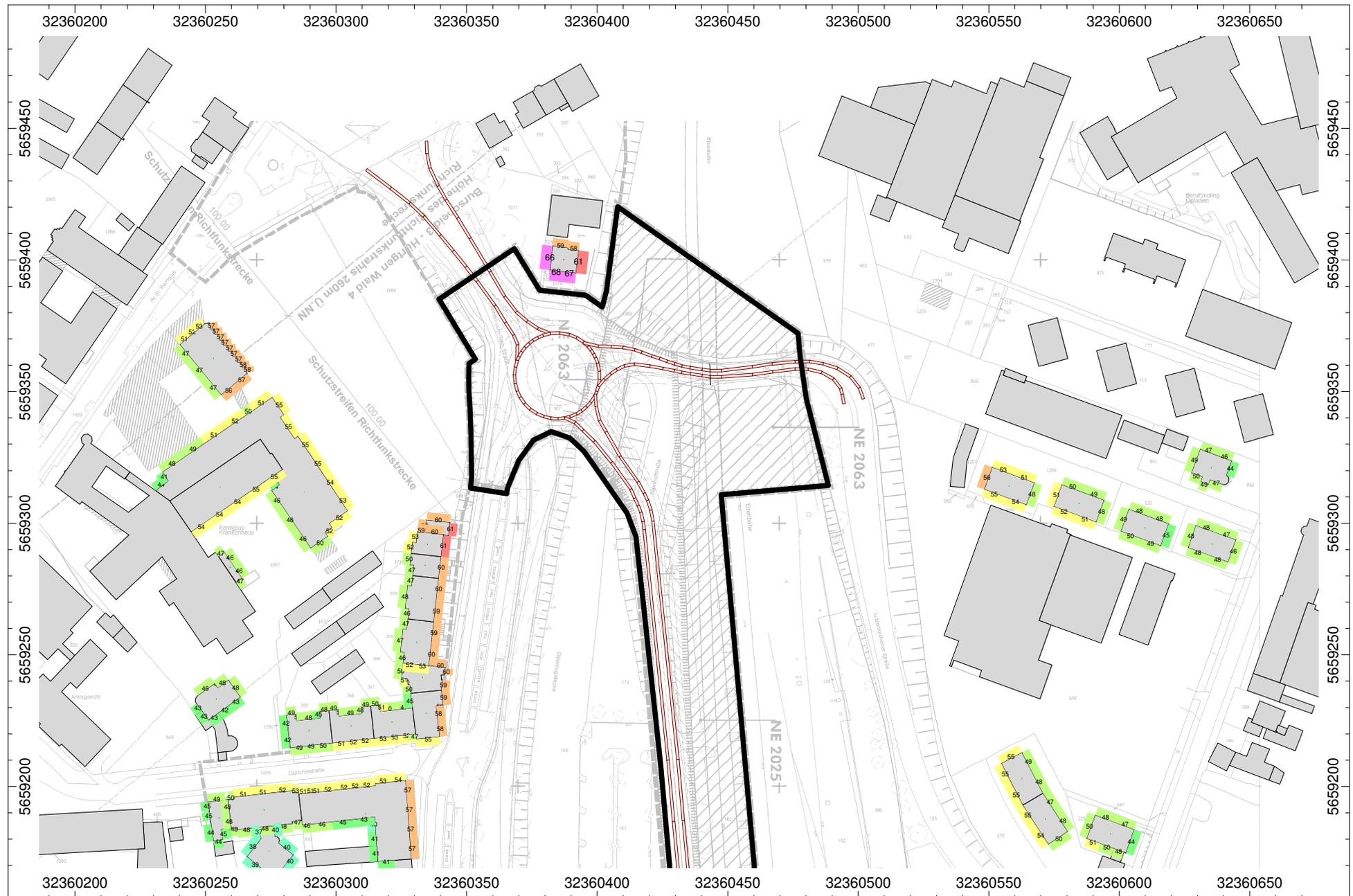
Abb. 3.2.1 maximale Fassadenpegel innerhalb des Ausbaubereichs tags - Teil 1
