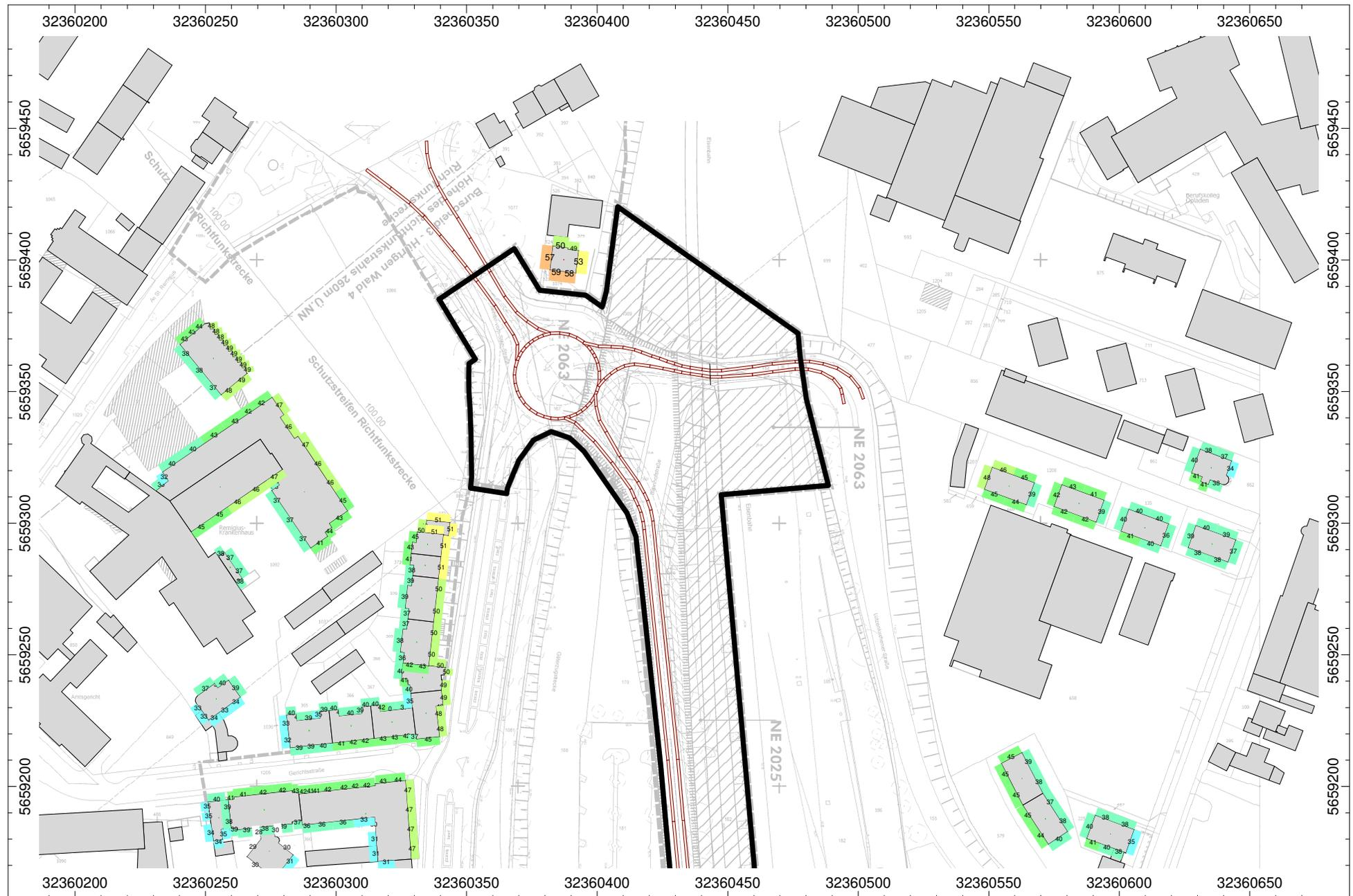
Abb. 3.2.2 maximale Fassadenpegel innerhalb des Ausbaubereichs nachts - Teil 1
