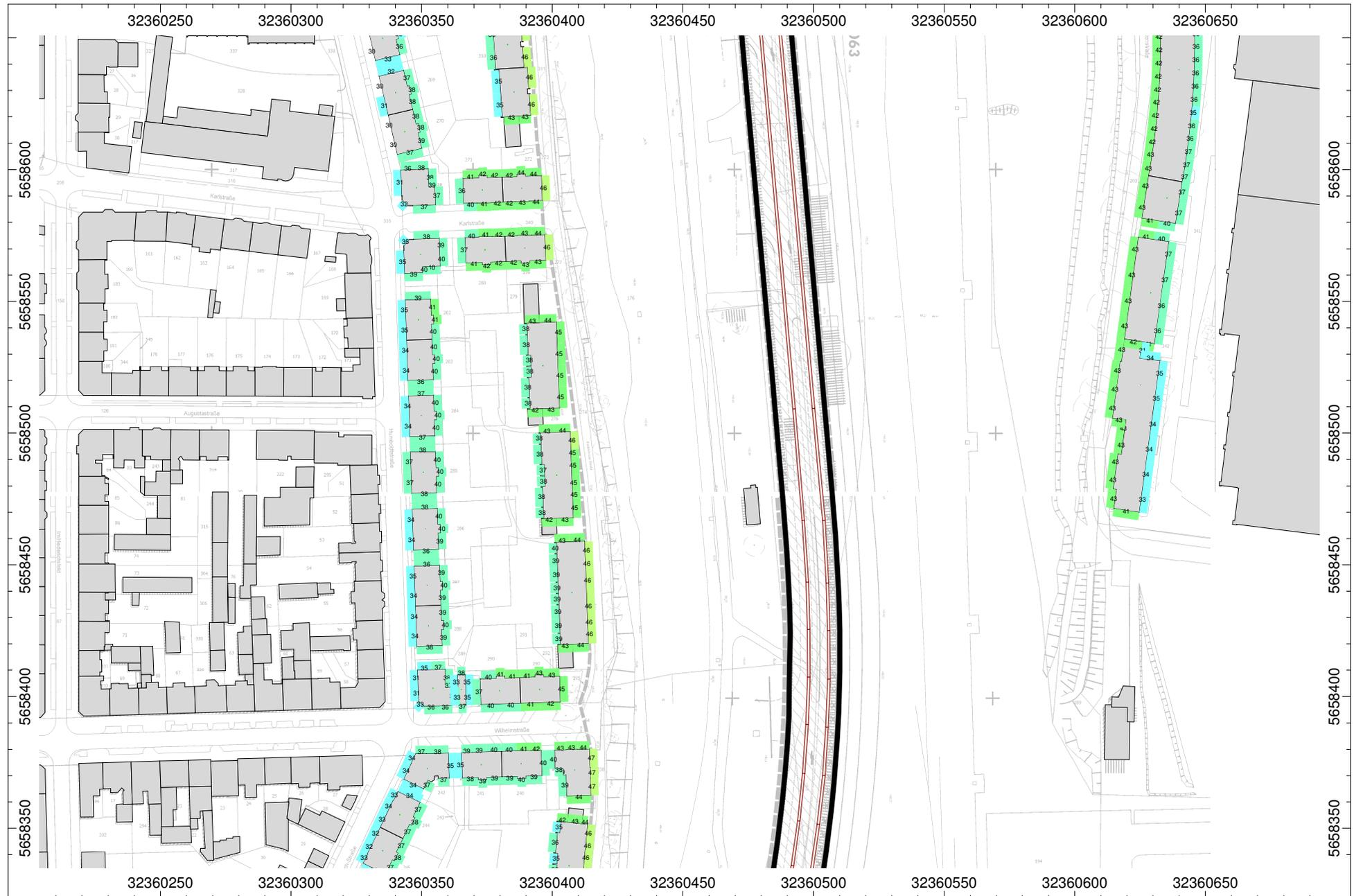
Abb. 3.2.8 maximale Fassadenpegel innerhalb des Ausbaubereichs nachts - Teil 4
