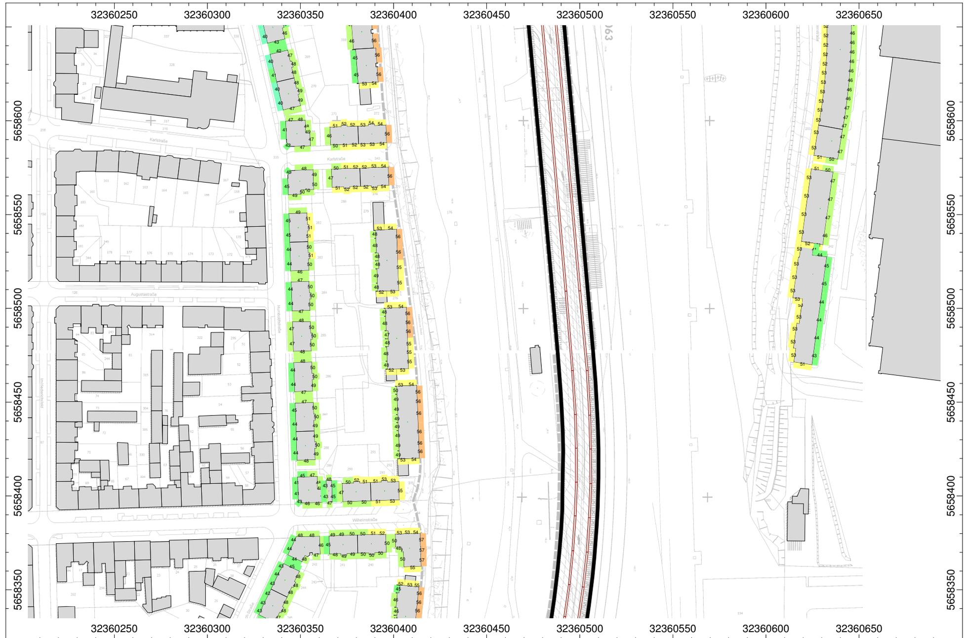
Abb. 3.2.7 maximale Fassadenpegel innerhalb des Ausbaubereichs tags - Teil 4
