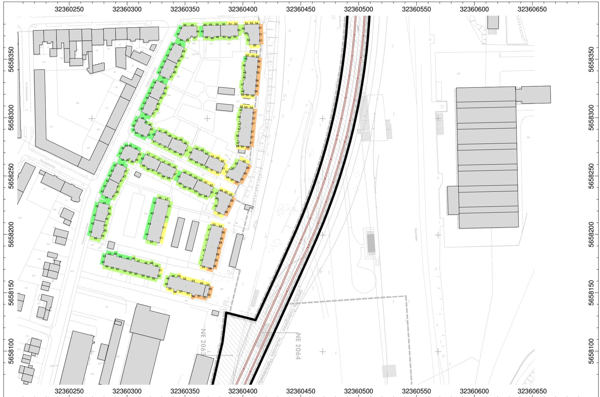
Abb. 3.2.9 maximale Fassadenpegel innerhalb des Ausbaubereichs tags - Teil 5
