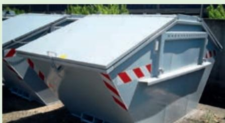
Tagsüber werden das Bohrgut und der zukünftig anfallende Aushub aus der Altablagerungsfläche in verschließbaren Containern gesammelt. So wird der Kontakt mit der Umwelt verhindert und einer Geruchsentwicklung vorgebeugt.
