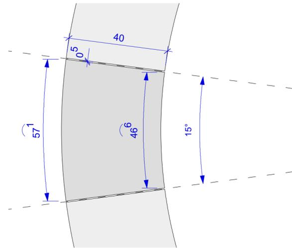
**DETAIL AUSSPARUNG STÜTZE M. 1 : 10**
