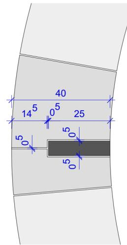
**GRUNDRISS STÜTZENKRANZ M. 1 : 20**
