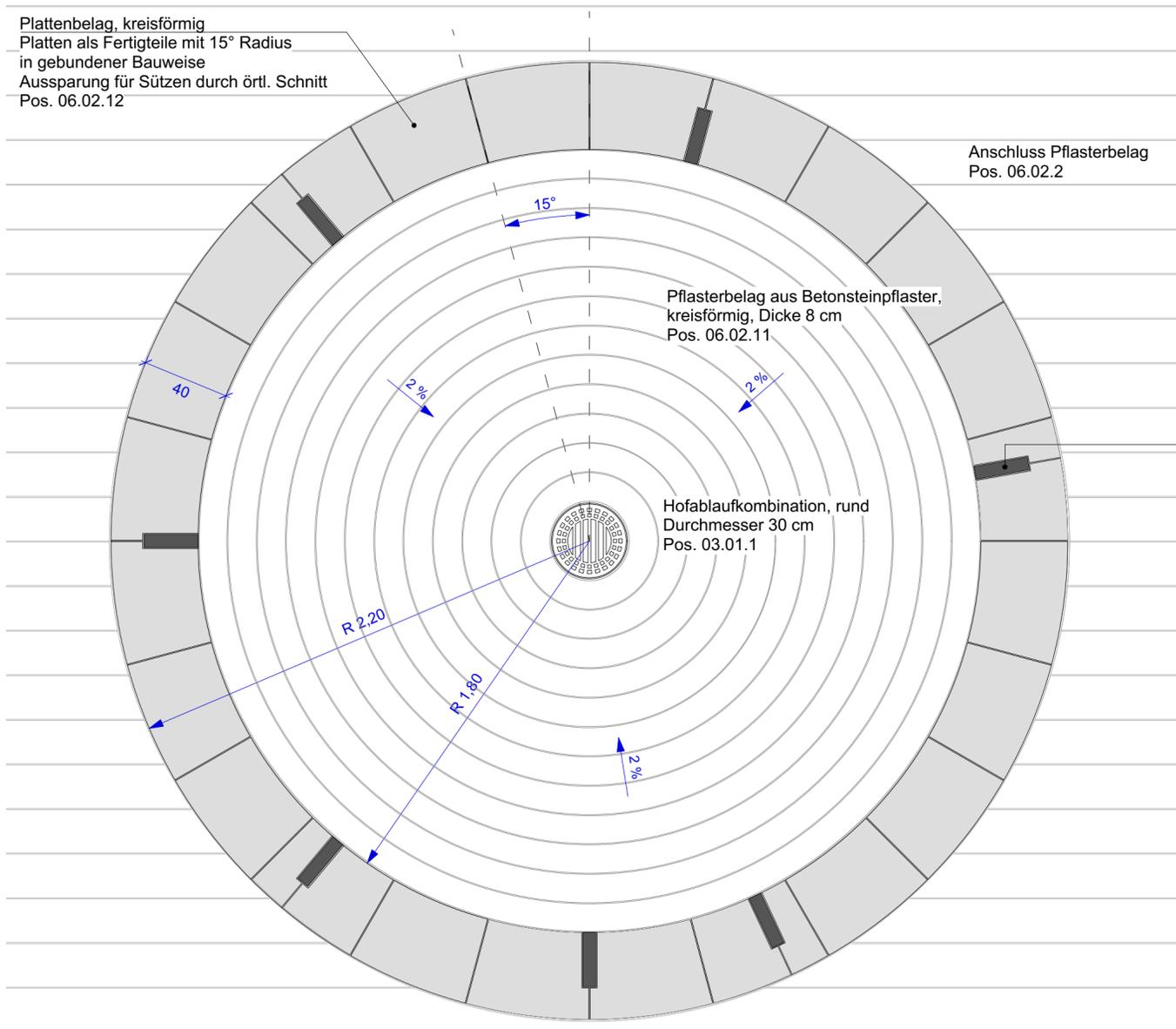
Pflasterbelag aus Betonsteinpflaster,
