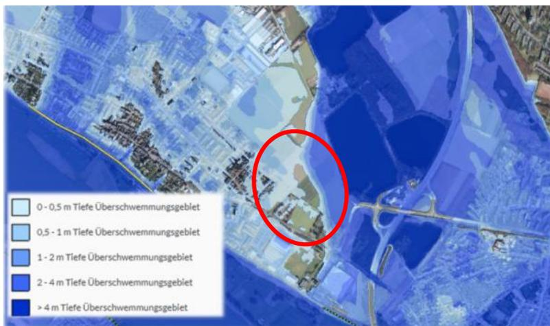
Abb. 6: Hochwassergefahrenkarte, Szenario HQ<sub>500</sub> (verändert nach [www.uvo.nrw.de](http://www.uvo.nrw.de), Zugriff am 20.02.2017)
