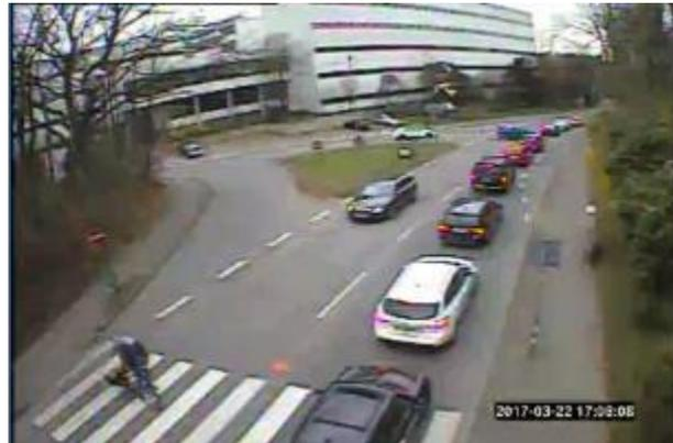
Abb. 5-1: Durch den Rückstau wird Fahrzeugen aus der Stauffenbergstraße das bevorrechtigte Einfädeln ermöglicht (blaues und weißes Fahrzeug)
