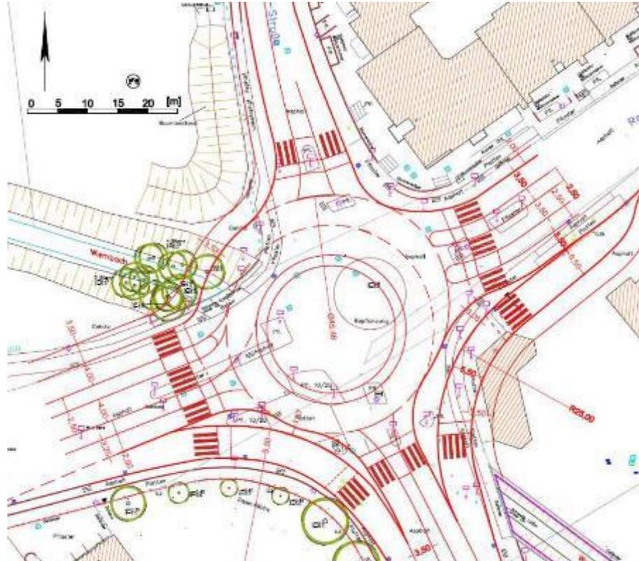
Abb. 6-6: *Halbseitig zweistreifiger Kreisel (B) mit alternativer Fahrstreifenaufteilung im Ring für konfliktarme Führung der Hauptströme*
